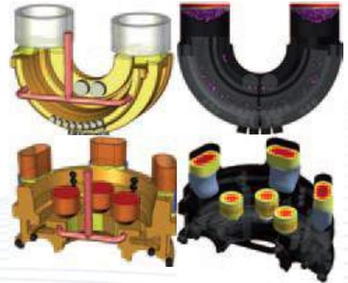
Diseño final después de 5 iteraciones mostrando no más puntos caliente
