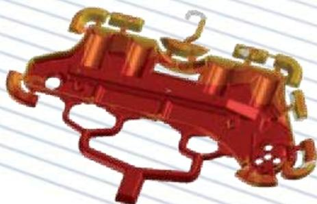
Fundición en molde permanente a alta presión
