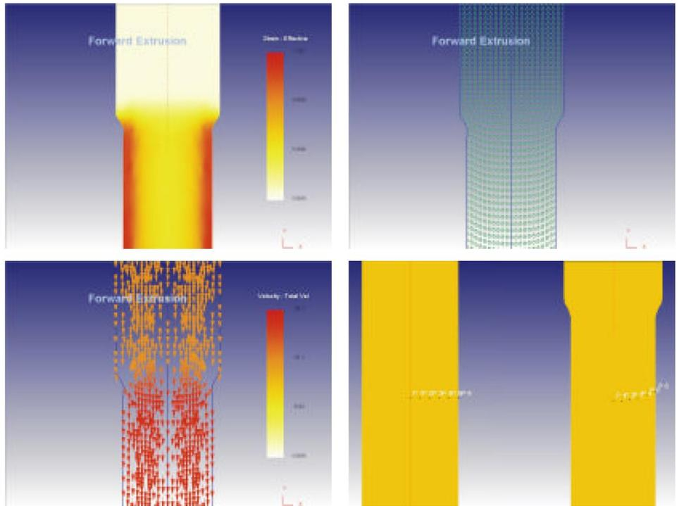
Se muestran los resultados de una simulación de una extrusión en frío. Contorno de deformación (superior izquierda), flujo de los granos utilizando FLOWNET (superior derecha), vectores de velocidad durante el formado (inferior izquierda) y el seguimiento de puntos al inicio y final (inferior derecha); los cuales representan los resultados típicos.
