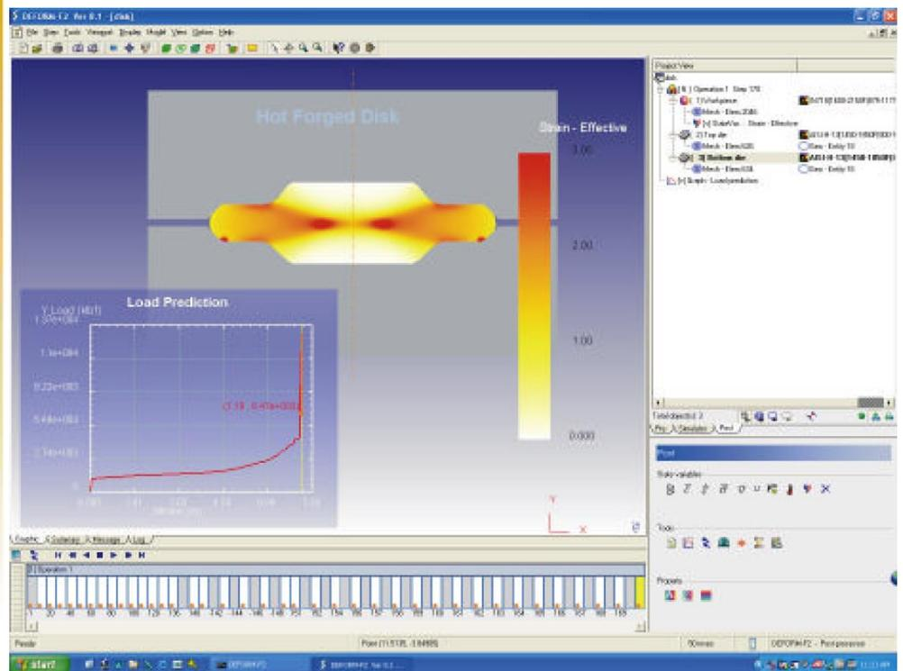
DEFORM-F2 proporciona un ambiente para la simulación de formado de metales eficiente y fácil de aprender. El ejemplo de arriba muestra el Post Procesador con un contorno mostrando la deformación y una gráfica de la curva Carga-Carrera para un disco de turbina de forja en caliente.
