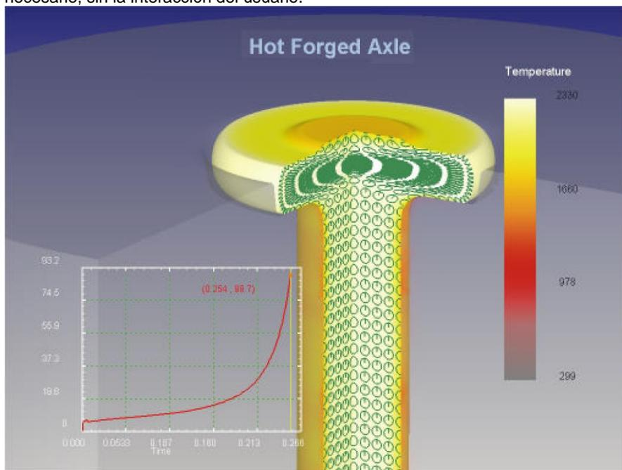
*Se muestran los resultados del Post Proceso (utilizando DEFORM-TOOLS) en un eje de forja en caliente. En la pieza de trabajo se muestra el contorno de la temperatura. En la parte inferior izquierda se observa la curva Carga-Tiempo. El FLOWNET muestra el flujo de los granos (círculos verdes).*
