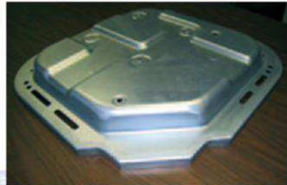
Parte física obtenida bien a la primera vez basados en trabajo de simulación, Cortesía de: Doerfer Companies
